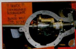
Proposto dalla lombarda No Poser ([www.noposer.com](http://www.noposer.com)), il differenziale modulare della inglese Kam, un robusto autobloccante con possibilità di bloccaggio manuale al 100%.
