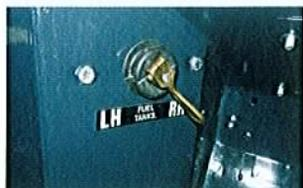
La Lightweight è dotata di due serbatoi del carburante: nella foto, la levetta che permette di utilizzare l'uno o l'altro
