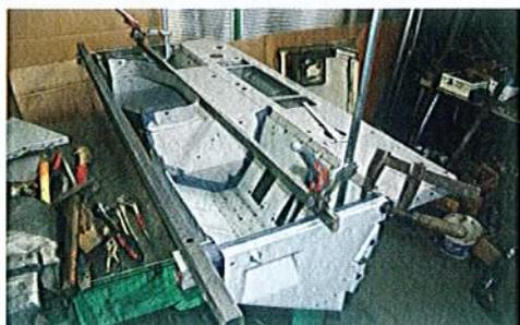
Il bulkhead pronto per la saldatura
