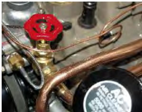
Fu messo olio nuovo, uno strumento per misurarne la pressione e un radiatore dell'acqua e dopo un giro di chiave, è partita subito girando regolarmente con una corretta pressione dell'olio: non valeva dunque assolutamente la pena revisionarlo, bastava spazzolare esternamente testa e cilindro che sono stati poi verniciati nel caratteristico color nocciola. (Foto 19) A questo punto abbiamo iniziato a
