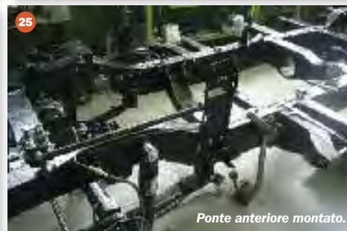
25 Ponte anteriore montato.
