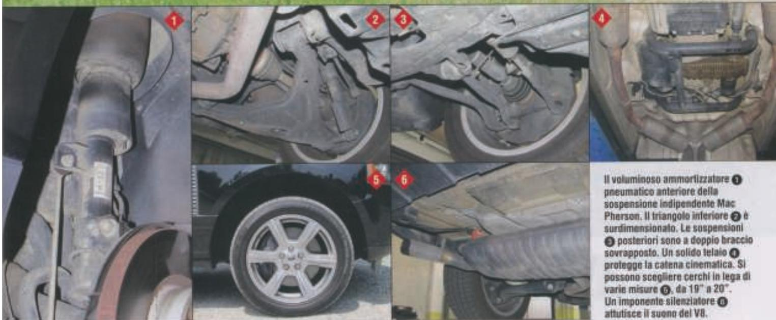
Il voluminoso ammortizzatore 1 pneumatico anteriore della sospensione indipendente Mac Pherson. Il triangolo inferiore 2 è surdimensionato. Le sospensioni 3 posteriori sono a doppio braccio sovrapposto. Un solido telaio 4 protegge la catena cinematica. Si possono scegliere cerchi in lega di varie misure 5, da 19" a 20". Un imponente silenziatore 6 attutisce il suono del V8.
