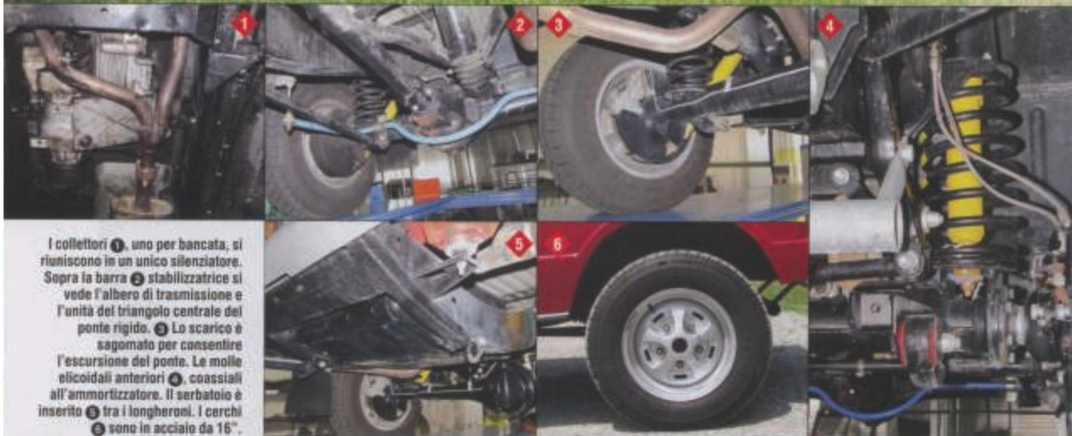
I collettori 1, uno per bancata, si riuniscono in un unico silenziatore. Sopra la barra 2 stabilizzatrice si vede l'albero di trasmissione e l'unità del triangolo centrale del ponte rigido. 3 Lo scarico è sagomato per consentire l'escursione del ponte. Le molle elicoidali anteriori 4, coassiali all'ammortizzatore. Il serbatoio è inserito 5 tra i longheroni. I cerchi 6 sono in acciaio da 16".
