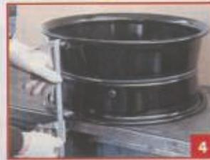
**Misura accurata.** Con un calibro, in caso di emergenza con un metro, si misura la larghezza interna del canale del cerchio.
