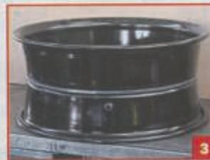
**Sigillato.** Si appoggia il secondo anello sul disco con una seconda guarnizione, necessaria perché il tubeless tenga la pressione.
