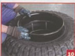
**Montaggio.** È giunto il momento di inserire il primo anello del cerchio, che è universale per pneumatici tubeless e tube type.
