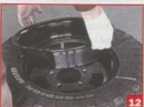
**Assemblaggio.** Da ultimo, si appoggia l'altro anello sul disco centrale del cerchio e la ruota completa prende forma.
